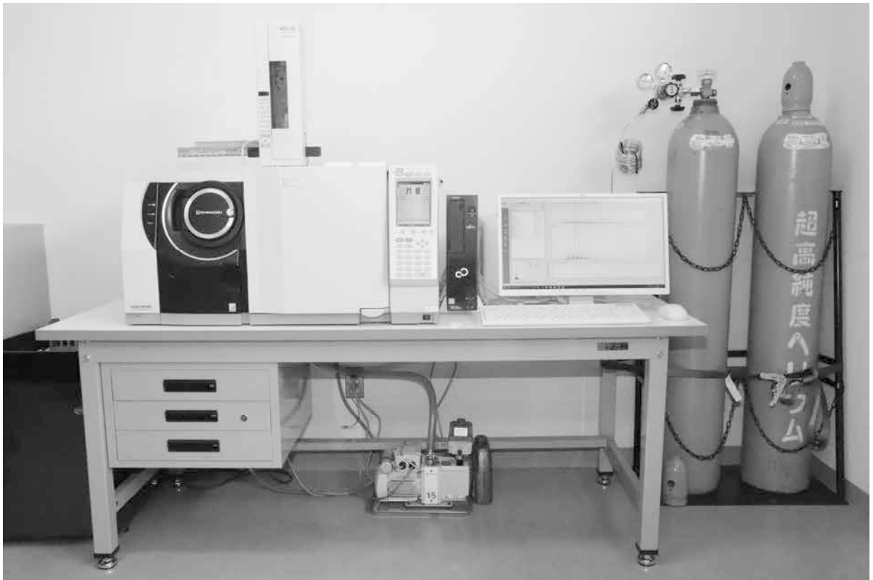
●龍ヶ崎消防署火災調査室 ガスクロマトグラフ質量分析計
